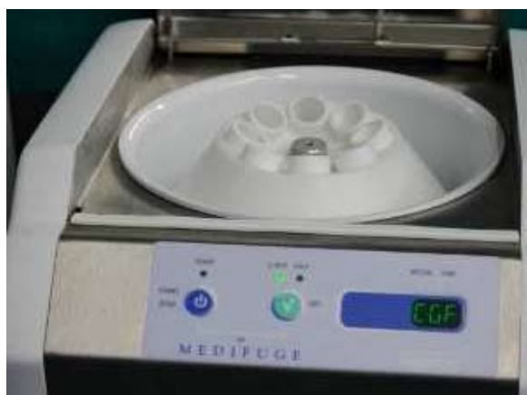
Fig. 7 Separatore di fasi ematiche Medifuge (Silfradent Italy). Questo apparecchio è settato per assicurare il controllo delle velocità e delle accelerazioni adeguate alla separazione delle fasi ematiche senza danneggiarne i componenti
