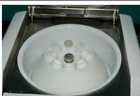
Fig. 8 Immagine del rotore monolitico di Medifuge. Questo componente essendo facilmente smontabile, ne consente la sterilizzazione
