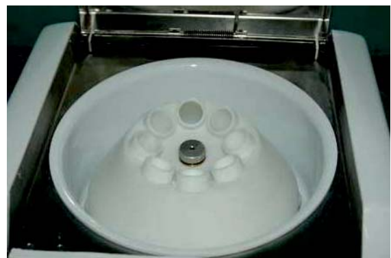
Fig. 8 Imagen del portaprobetas monolítico Medifuge Este componente es fácilmente desmontable y puede ser esterilizado en autoclave.
