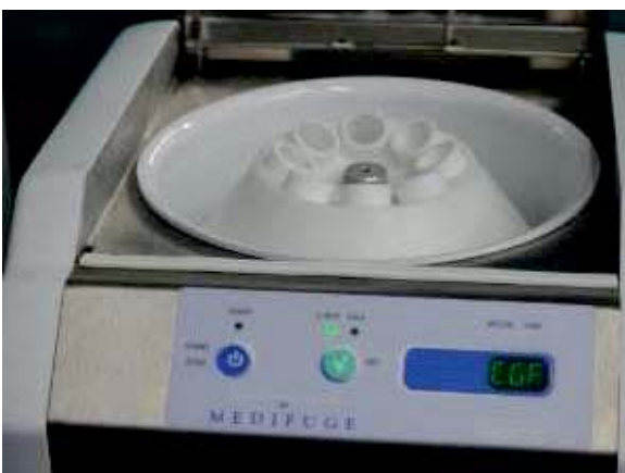
Fig. 7 Separador de fases hématicas Medifuge (Silfradent Italia). Este aparato está configurado para asegurar el control de la velocidad y de la aceleración adecuada para la separación de la fase hemática sin dañar los componentes.
