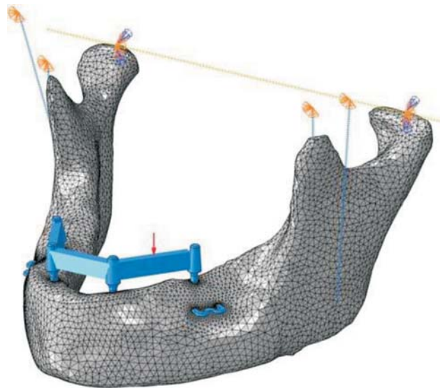
Figura 2 Modelo de mandíbula con implantes, puente y con músculos marcados, condiciones de contorno y fuerza de carga.
