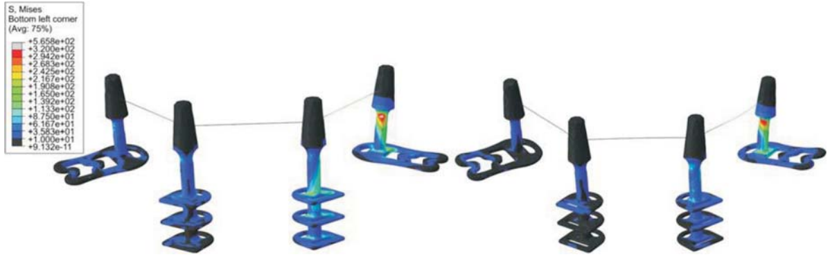
Figura 4 Contornos de estrés de Von Mises en todos los implantes. Recién operado a la izquierda, hueso sano a la derecha.
